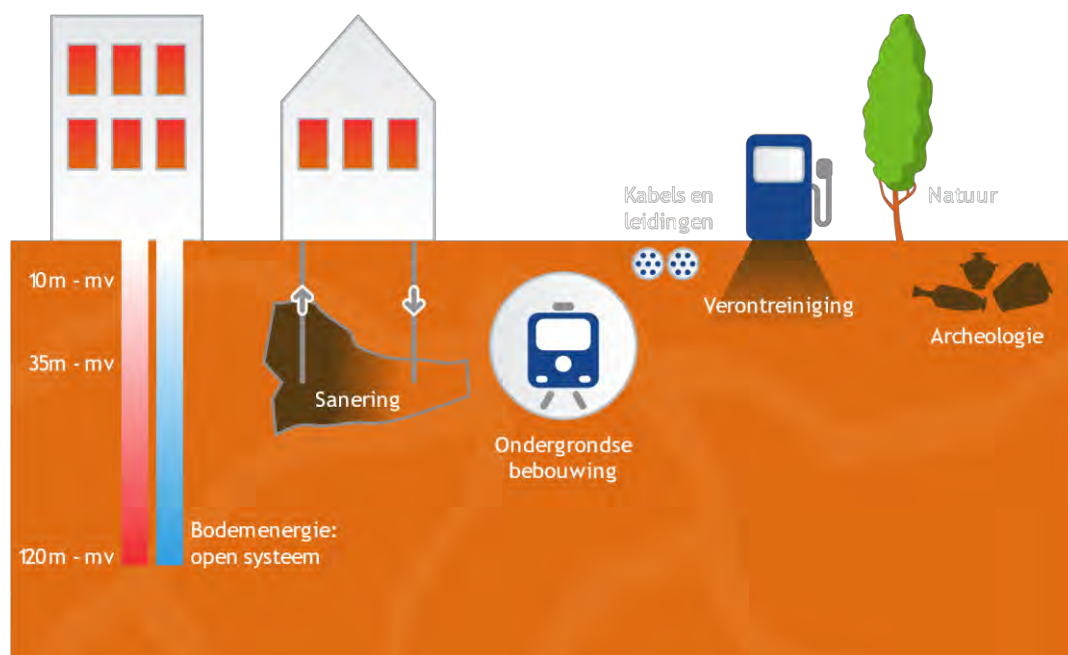
Figuur 1.2 | Overzicht ondergrondse functies
